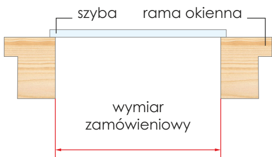
Przekrój okna prostego
